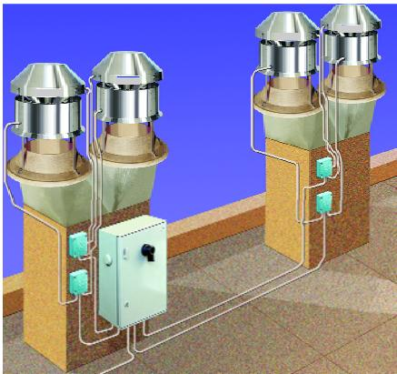
Sistema de control único en el mercado. Mediante el armario programable podemos fijar los distintos parámetros de control en función de las características de la ubicación del Sistema:
