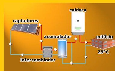
Instalación ACS con apoyo al sistema de calefacción
