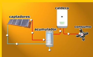
Instalación ACS (Agua Caliente Sanitaria)
