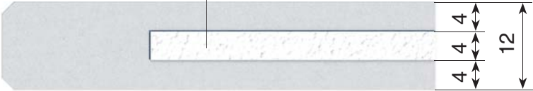
PANEL CON AISLAMIENTO POLIESTIRENO EXPANDIDO
