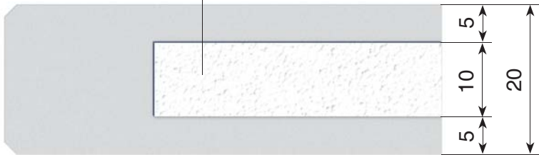
PANEL CON AISLAMIENTO POLIESTIRENO EXPANDIDO
