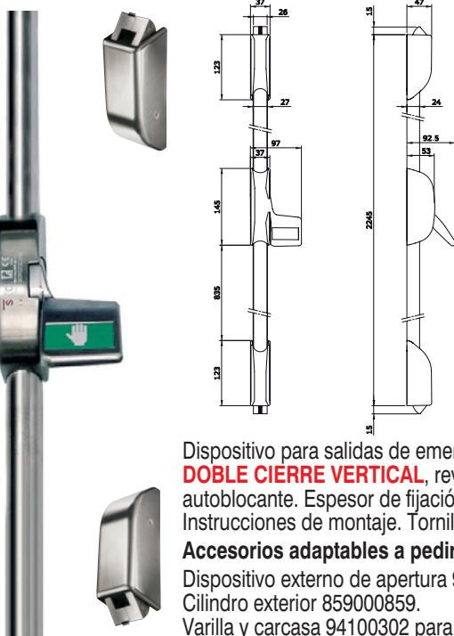
Dispositivo para salidas de emergencia accionado mediante **PLACA A PRESIÓN "PAD INOX" CORTAFUEGOS DOBLE CIERRE VERTICAL**, reversible. Varillas y carcasa para altura máxima 2.265 mm. Resbalón de acero autolocalizante. Espesor de fijación de nylon. Cerraderos para alto / bajo con espesores de 1-2 -3 mm. Plantilla. Instrucciones de montaje. Tornillos de fijación.
