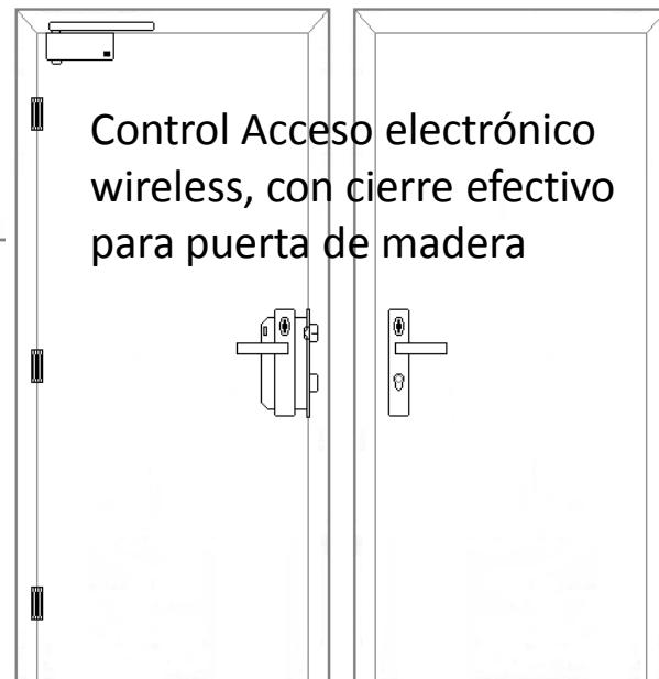
Control Acceso electrónico wireless, con cierre efectivo para puerta de madera
