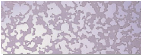
La profundidad del grabado se controla mediante el tiempo en que el acero inoxidable está expuesto al ácido.
