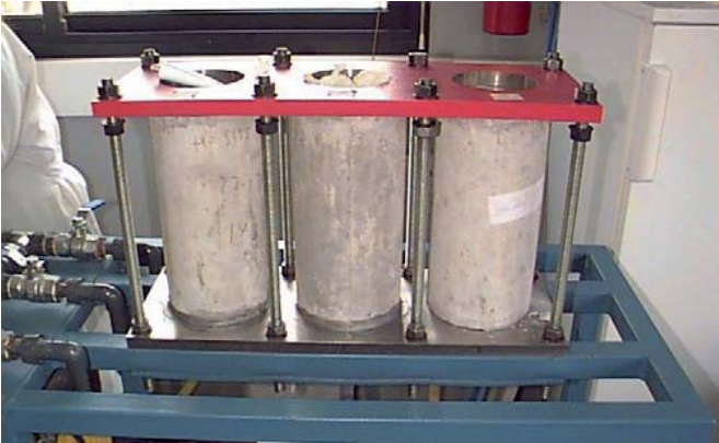
Determinación de la profundidad de penetración de agua bajo presión
