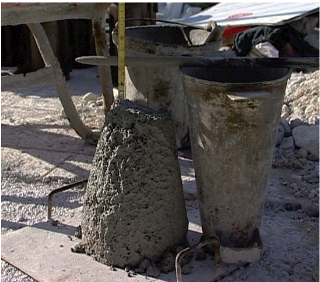
Ensayo de consistencia, mediante cono de Abrams.
