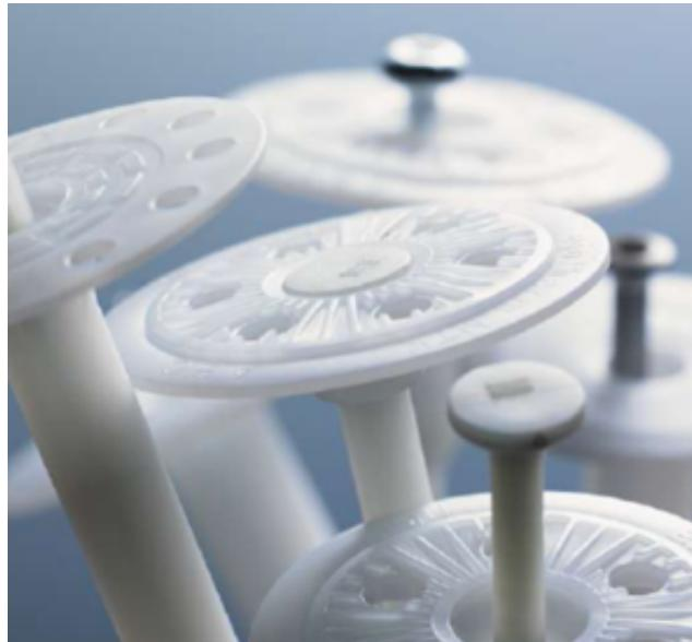
El anclaje plástico o espiga que se utiliza en combinación con los adhesivos para fijar los paneles aislantes al soporte debe estar inyectado en material termoplástico aislante para evitar la propagación de la llama y debe disponer del Marcado CE según Guía DITE 014. El elemento de expansión para asegurar un buen anclado suele ser metálico o de poliamida.
