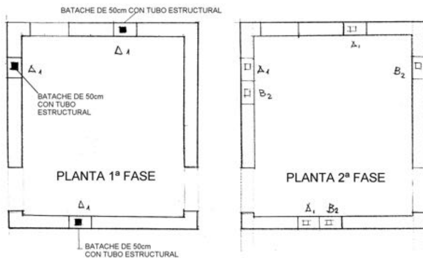
Proceso de bataches en el muro hasta completar todo el perímetro dejando las esquinas para el final
