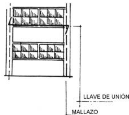
Fig. 43 b : SOLUCION CON LLAVES Y MALLAZO
