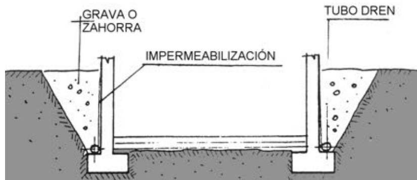
Fig. 32 : AISLAMIENTO DE LA CIMENTACION EN ARCILLAS EXPANSIVAS
