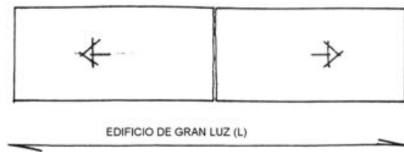
Fig. 44 : GRIETA POR FALTA DE JUNTA DE DILATACION
