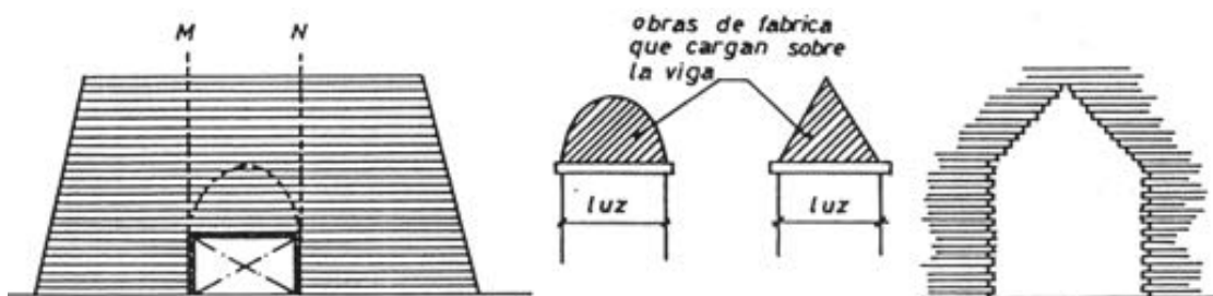
Fig 34: Cargas que actúan para el efecto arco
