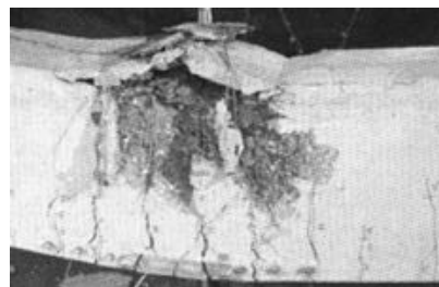
Rotura por agotamiento del acero
