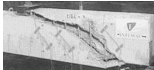
Fallo de anclaje en estribos
